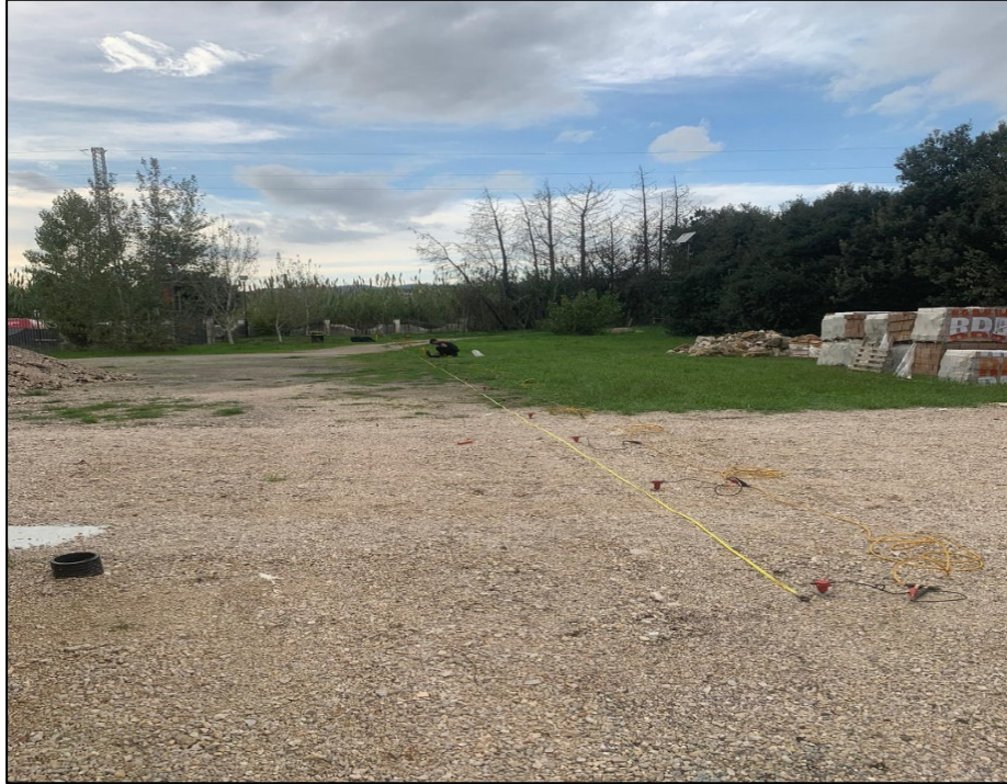
Foto 1: Stendimento di 24 geofoni a frequenza di 4.5 Hz.
